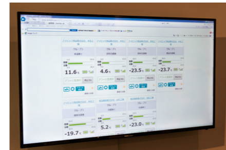
工場内の冷蔵・冷凍庫はIoTによる温度管理を行いモニターにも表示(左)。品質管理で問題が発生した時はビデオで作業内容を確認できます(右)。
