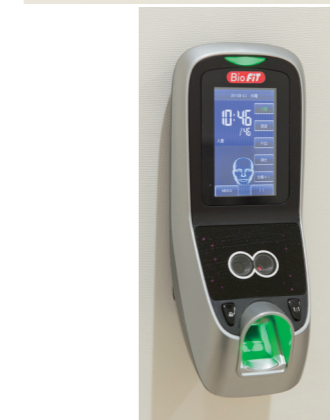
工場入口の「ISO22000認証取得工場」の表示(上)。工場の入退室はすべて顔認証システムでドアロックを解除します(下)。
