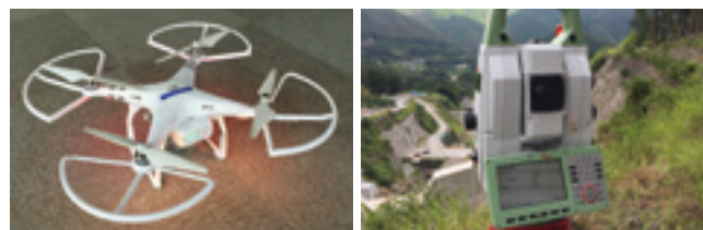
レーザースキャナー搭載のドローン(左)と地上型レーザースキャナー本体(右)
