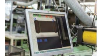
自動的に製品のサイズを測定してくれる画像検査機のモニター
