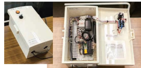
「ラズベリーパイ」を活用して自社製作した機械動作情報収集装置
