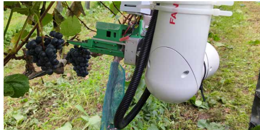
写真④/ロボットハンドによる自動収穫の実証実験 提供：北海道大学 生研支援センター事業「オープンイノベーション研究・実用化推進事業」より
