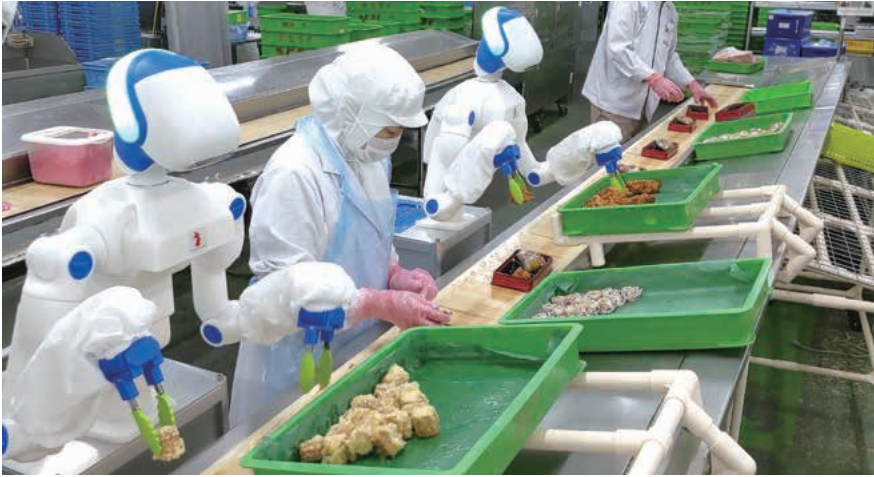
画像②：人型協働ロボットFoodlyは、ばら積みされた食材を一つひとつ認識してピッキングし、弁当箱・トレイへ盛りつけするまでの作業を1台で完結させる
