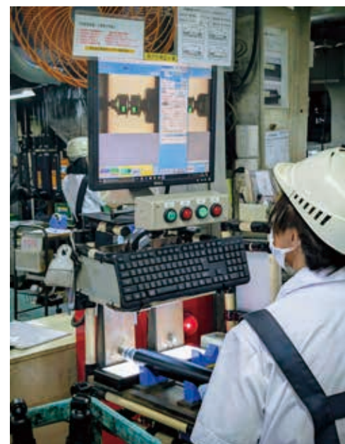
画像②：規格に満たない場合は赤ランプが灯り作業者に知らせる
