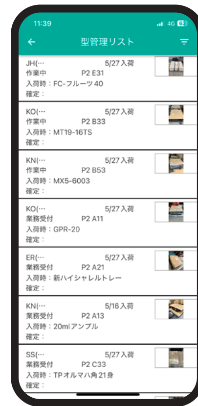
画像②／「Kata Kan」のスマホ画面。 金型の保管状況・保管場所が金型に付したQR ラベルで登録・更新する
