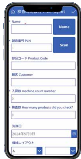
画像①／島崎さんが開発した「検査記録アプリ」の操作画面。手書き記入やパソコンへの転記の必要をなくし、工数を削減
