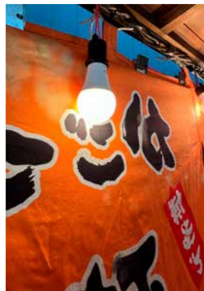
写真①：IoT電球を灯すと、SIMから「営業中」という情報が送信され、LINEアカウントに反映される仕組みになっている
