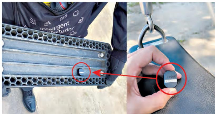
写真①：園の遊具の実証実験は、ブランコの踏み台の裏などにセンサーを取り付けて実施された
