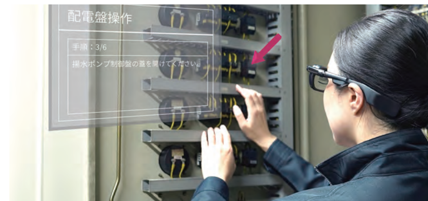
写真：経験の浅い作業者にスマートグラスの視界に分かりやすく指示が表示される
