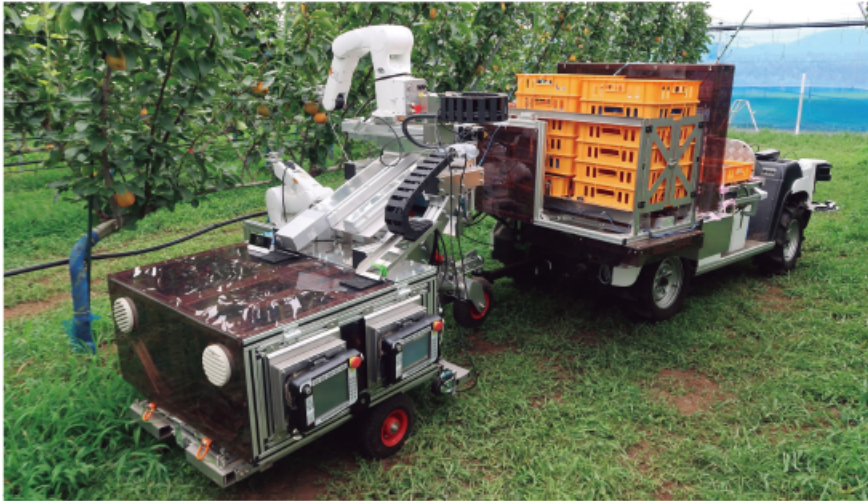
成熟した果実のみをAIが判定した上で収穫する「収穫ロボット」
