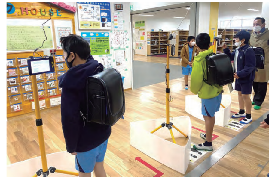
写真②：産官学連携で開発した学校向けの自動検温システム
