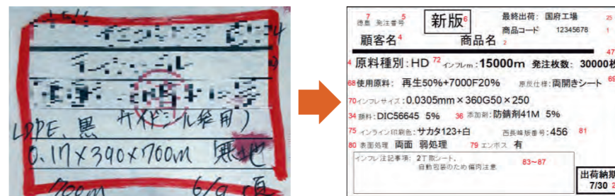
① 製造指示が記された手書きラベル(左)をDB化して見やすくプリンターで出力(右)
