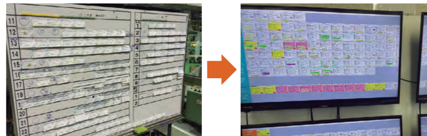
② 2017年には指示ラベルの出力も廃止され、電子掲示板(右)での管理へ移行した
