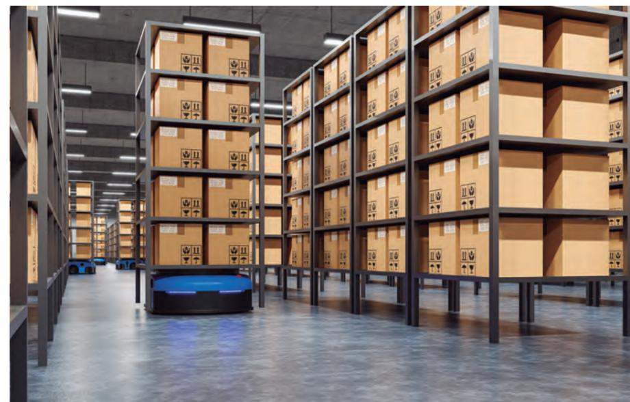
棚を運ぶロボット(青いロボットが棚を運び、人のいる場所まで移動する)
