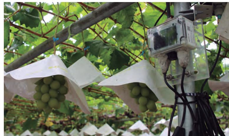
ハウス内に設置されたセンサーが、温度、湿度、照度などを常時観測
