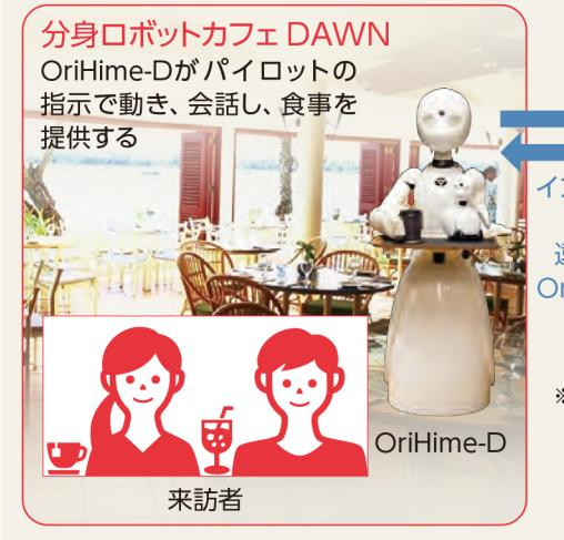
※「OriHime-D」は、カフェでの接客など身体労働をともなう業務に向けて開発された、身長約120cmの分身ロボット。OriHime同様にカメラ、マイク、スピーカーを搭載。前進後退、旋回のほか、上半身の内蔵する14個の関節用モーターで、物をつかんで運ぶ機能も備える。
