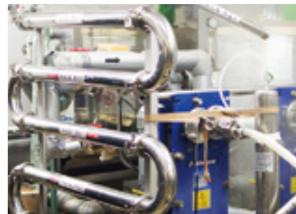
工程のほとんどは人手作業だが「火入れ」工程は新方式「プレートヒーター急冷却火入れ」で行っている
